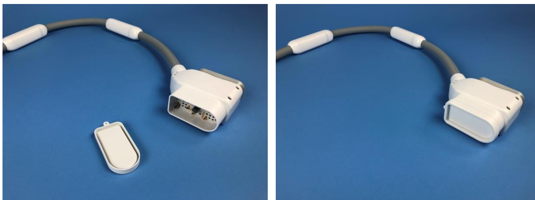
Figura 13: Fixe a tampa no conector da bobina da Endorectal Coil.
