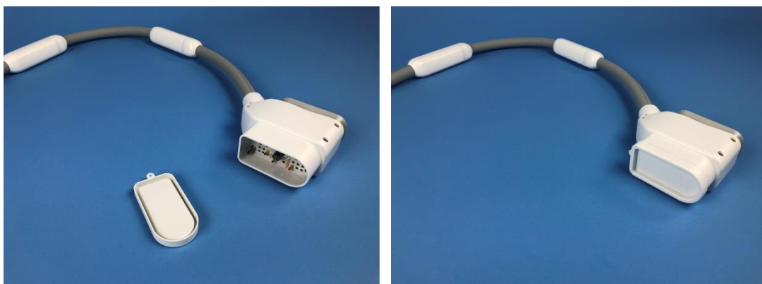
Figur 13: Fest dekselet på spolekontakten på Endorectal Coil.
