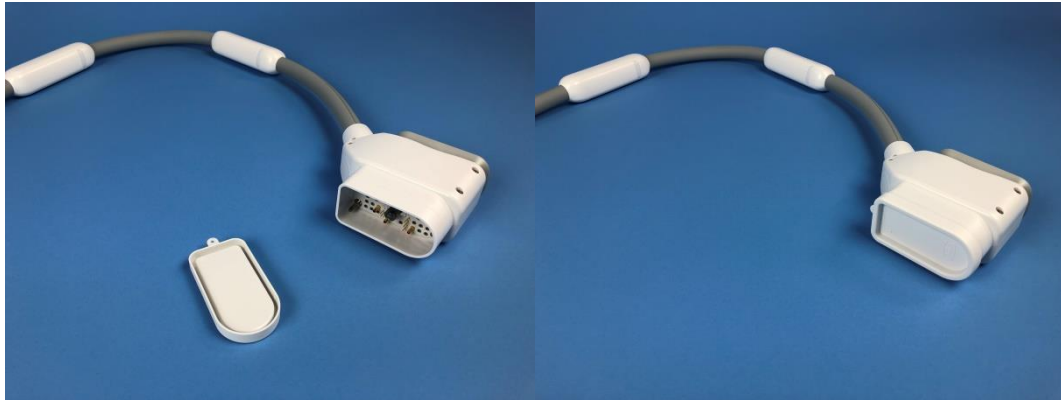
図13: 直腸内コイルのコイル接続部にカバーを取り付ける。
