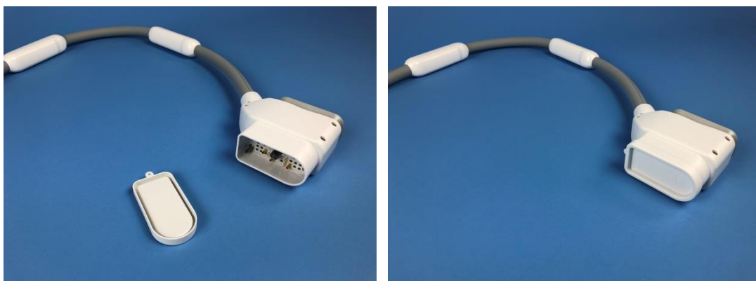
Joonis 13: Katte kinnitamine Endorectal Coili spiraalipistikule.
