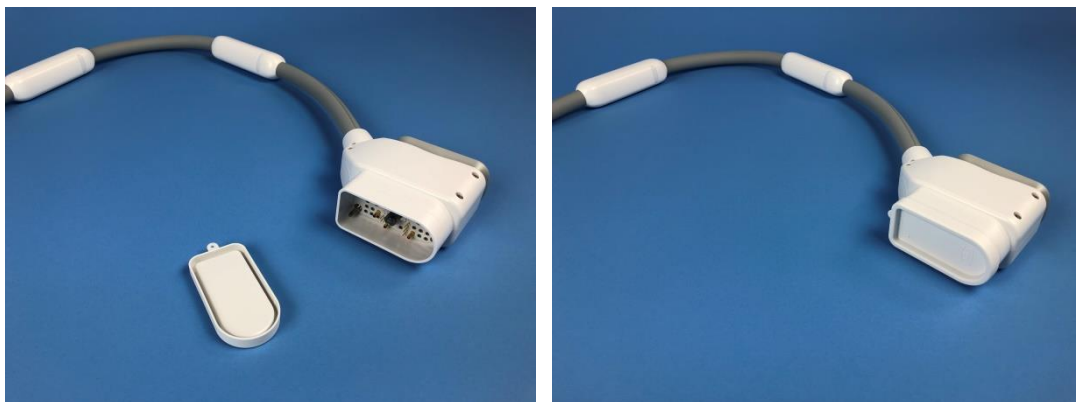
Abbildung 13: Befestigen Sie die Abdeckung auf dem Spulenanschluss der Endorektalspule.
