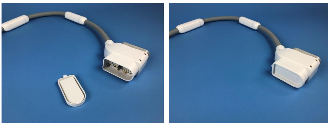
Obrázek 13: Upevnění krytu na konektor Endorectal Coil.
