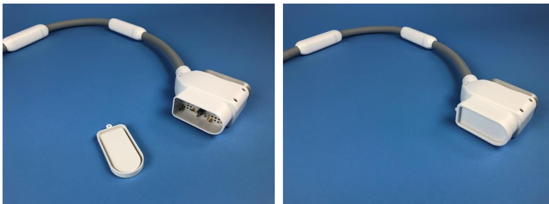
Фигура 13: Прикрепете покритието върху конектора на бобината на ендоректалната бобина.
