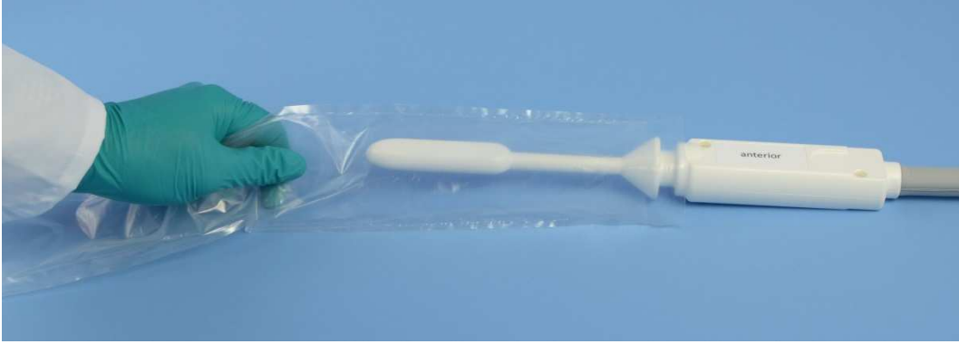
Şekil 6: Endorectal Coil'in bütünüyle dezenfekte edilmiş MR Probunun kılıfını çıkarın.
