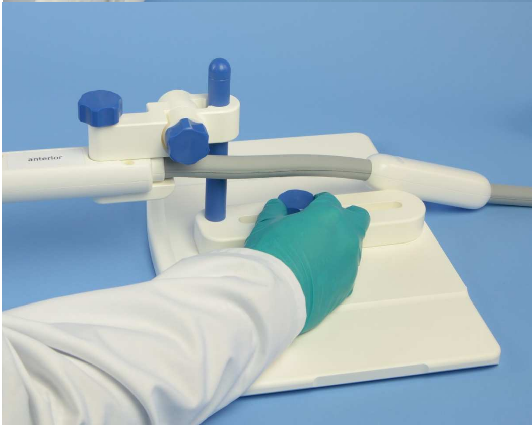
Figur 10: Varje endorektal MR-undersökning kräver en individuell positionering av spolen. ER-spolens stöd kan anpassas på lämpligt sätt genom användning av räfflade skruvar #2 och #3.
