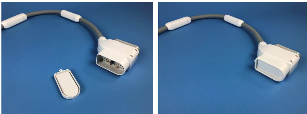
Figura 14: Atașați capacul pe conectorul bobinei de la Bobina endorectală.
