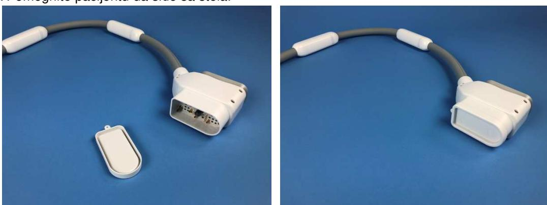
Slika 14: Pričvrstite poklopac na priključak endorektalne zavojnice.
