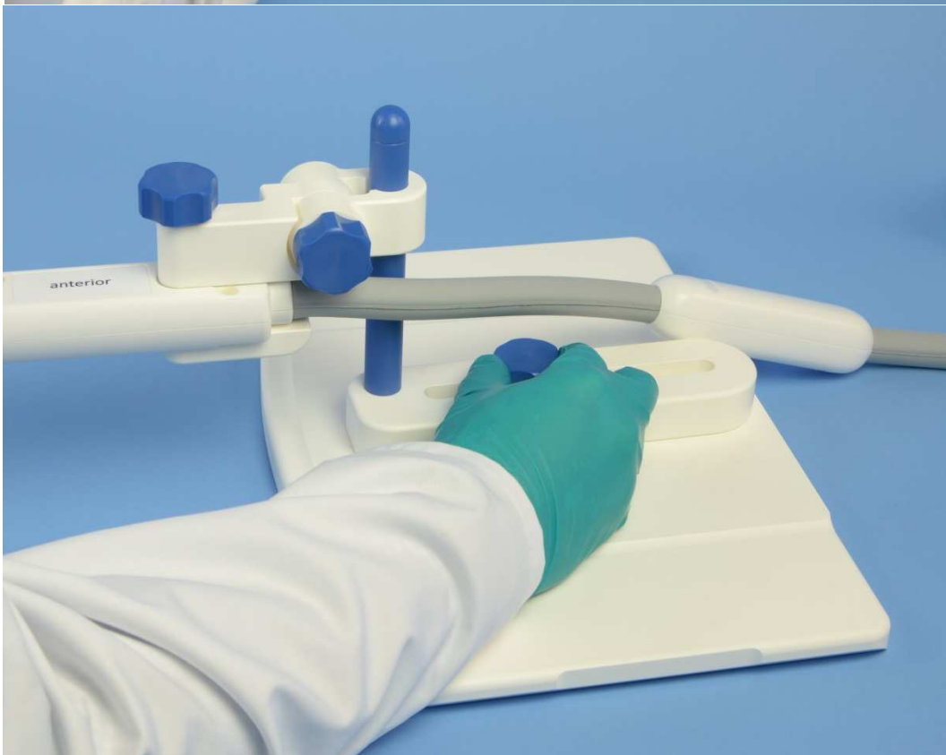
Joonis 10: Iga endorektaalne MR-uuring nõuab individuaalset spiraali positsioneerimist. ER Coil Support'i saab vastavalt kohandada, kasutades kinnituskruvisid 2 ja 3.
