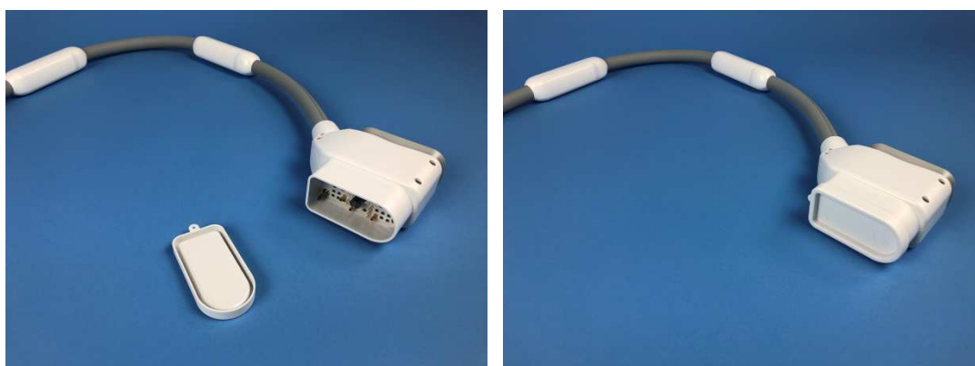
Obrázek 14: Upevnění krytu na konektor Endorectal Coil.
