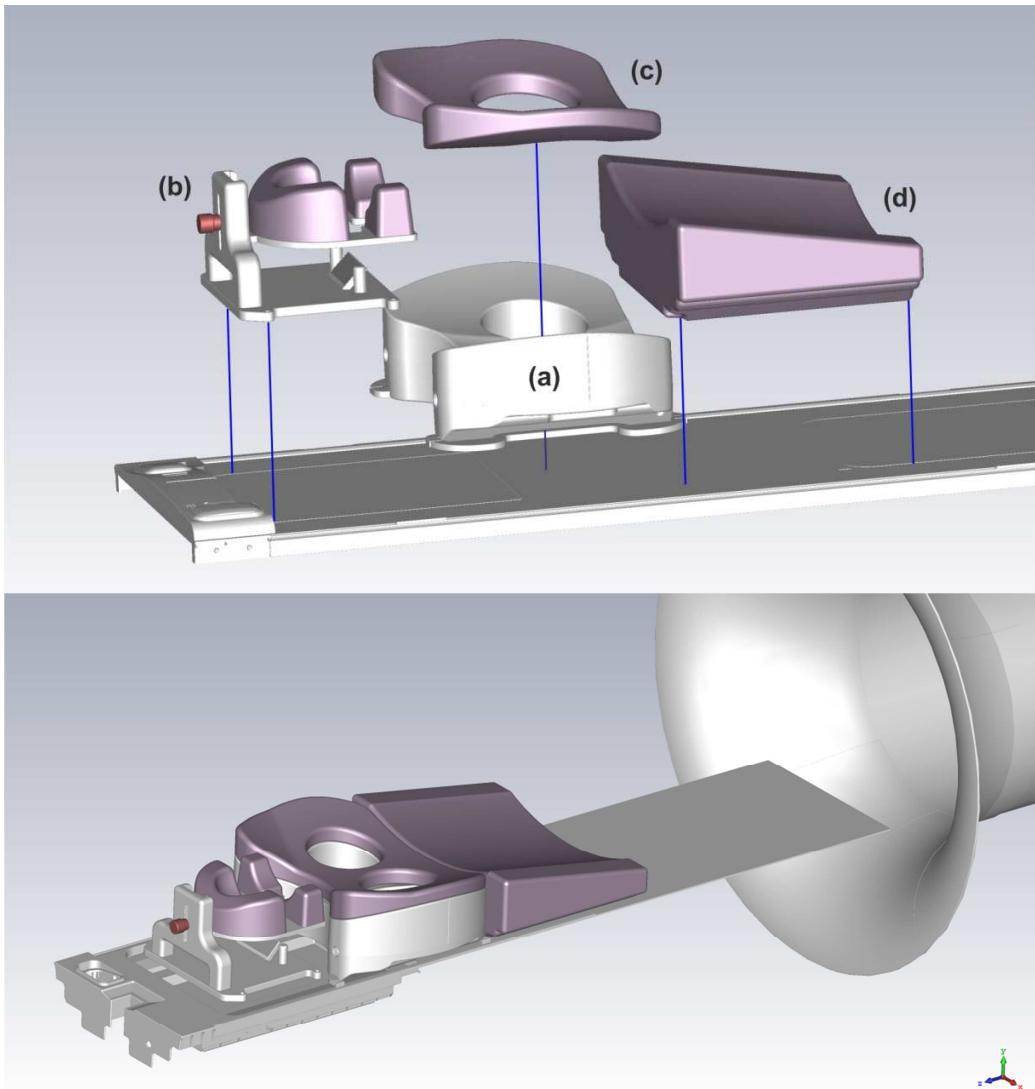
그림 2: GEM 환자 테이블이 있는 GE MR-System 의 16Ch Diagnostic Breast Coils 설치, breast coil(a), 머리 받침(b), 컴포트 패드(c) 및 램프 패드(d)로 구성.
