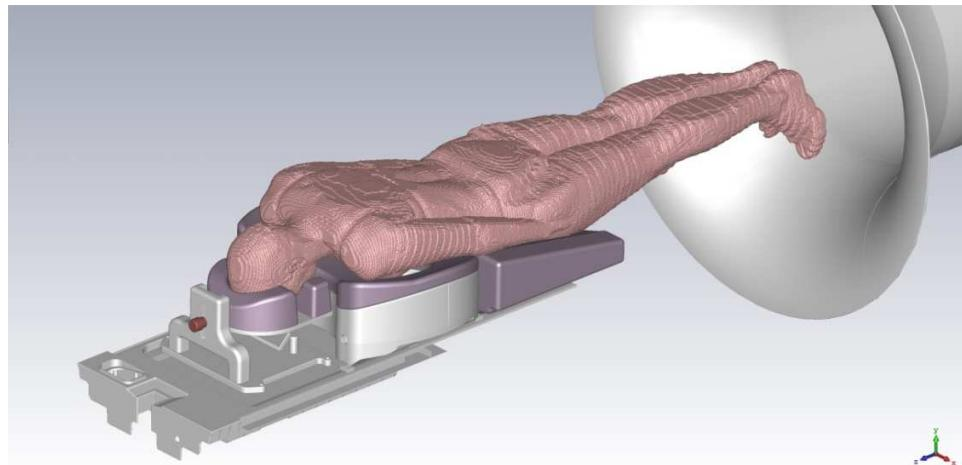
그림 6: 광폭 환자 테이블이 있는 GE MR-System 의 16Ch Diagnostic Breast Coils 설치.
