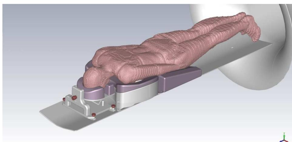
그림 7: B/GEM 환자 테이블이 있는 GE MR-System 의 16Ch Diagnostic Breast Coils 설치.
